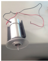
图 6 转动“随机微透镜阵列”结构 Fig. 6 Structure of rotating “random micro-lens array”
