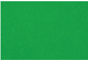
图 11 加入转动“随机微透镜阵列”后用 1/80 s 的曝光时间拍摄的散斑图像 Fig. 11 Image of the speckle with rotating “random micro-lensarray” exposed in 1/80 s
